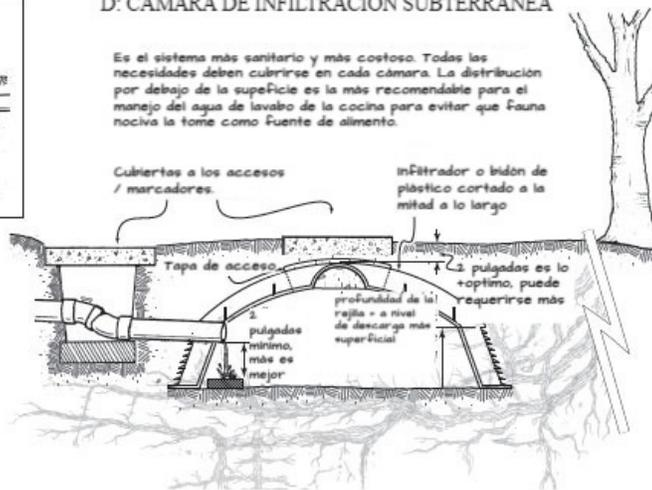
**Diferentes opciones de salida de la cuenca de mantillo, de la Guía de aguas grises para el constructor (Builders' Greywater Guide, Oasis Design)**
